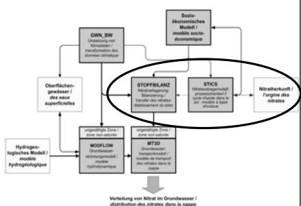
Modelle / modèles: Hydrogeologisches Modell, Interaktion Fliessgewässer/ Modèle hydrogéologique, échange nappe-rivière
