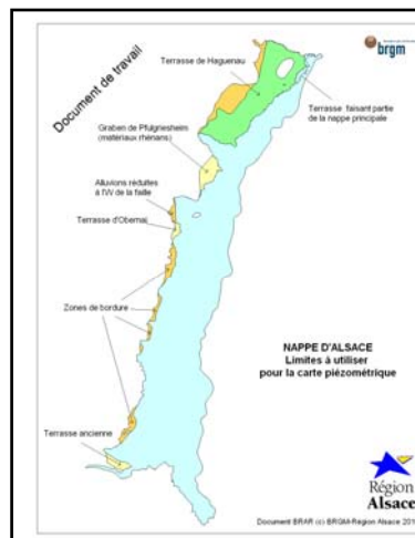
Modèle hydrodynamique : nouvelles bordures Ouest Fliess- und Transportmodells: neue Westgrenzen
